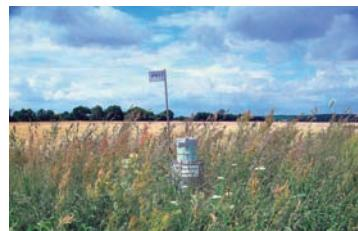
I) Zařízení na měření podzemní vody v ochranném vodním pásmu Canitz/Thallwitz
